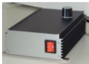
SR10, boîtier électronique de vitesse asservie.
